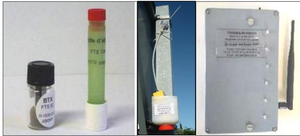
Figure 50 : De gauche à droite : tubes passifs, filtre en quartz et sa pompe, micro-capteur laser
