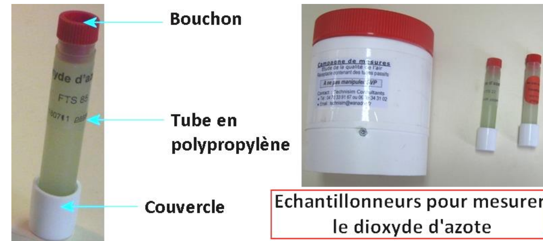
Figure 114 : Échantillonneur passif pour le dioxyde d'azote (Passam)
